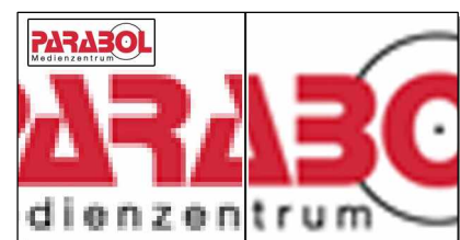
Vergrößerung einer Rastergrafik, links mit Pixelwiederholung, rechts mit bikubischer Interpolation
